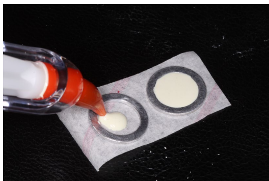
FIGURA 1 - manipulação dos Cimentos em Moldes Anelares
